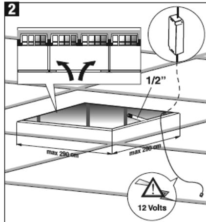
**Montagehinweis:** Beachten Sie die Rahmengröße auf Seite 9. Bei nachträglicher Montage gelten die angegebenen Ausschnittmaße. In diesem Fall, ist der Spalt zwischen Ausschnitt und Rahmen bauseits zu verschließen. Beim Einbau in eine Massivdecke die Haltetaschen des Einbaurahmens entfernen.
