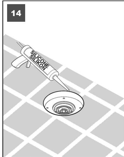
Abdichten des Spaltes zwischen Box und Belag mittels Silikon (essigfrei).
