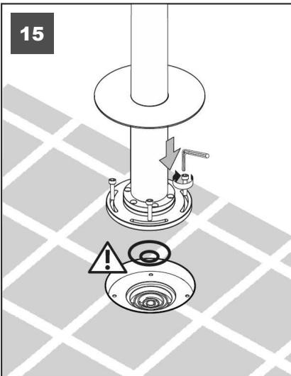
Platzieren der Armatur auf dem Messing-Sockel der Einbaubox. Befestigungsschrauben handfest anziehen und die Armatur ausrichten.
