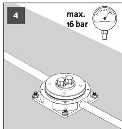
Nach Fertigstellung der kompletten Installation muss diese nach DIN 1988/EN 1717 gespült und auf Dichtheit geprüft werden.
