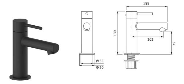
Lochbohrung Ø 35 mm *hole diameter*
