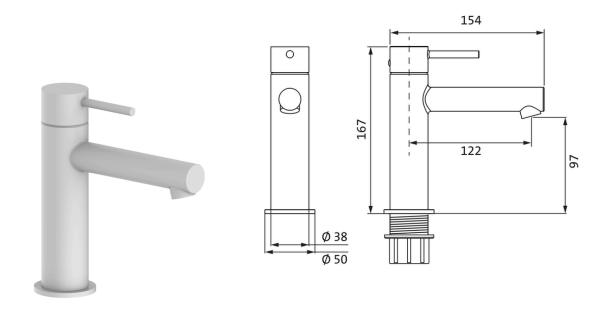
Lochbohrung Ø 35 mm hole diameter
